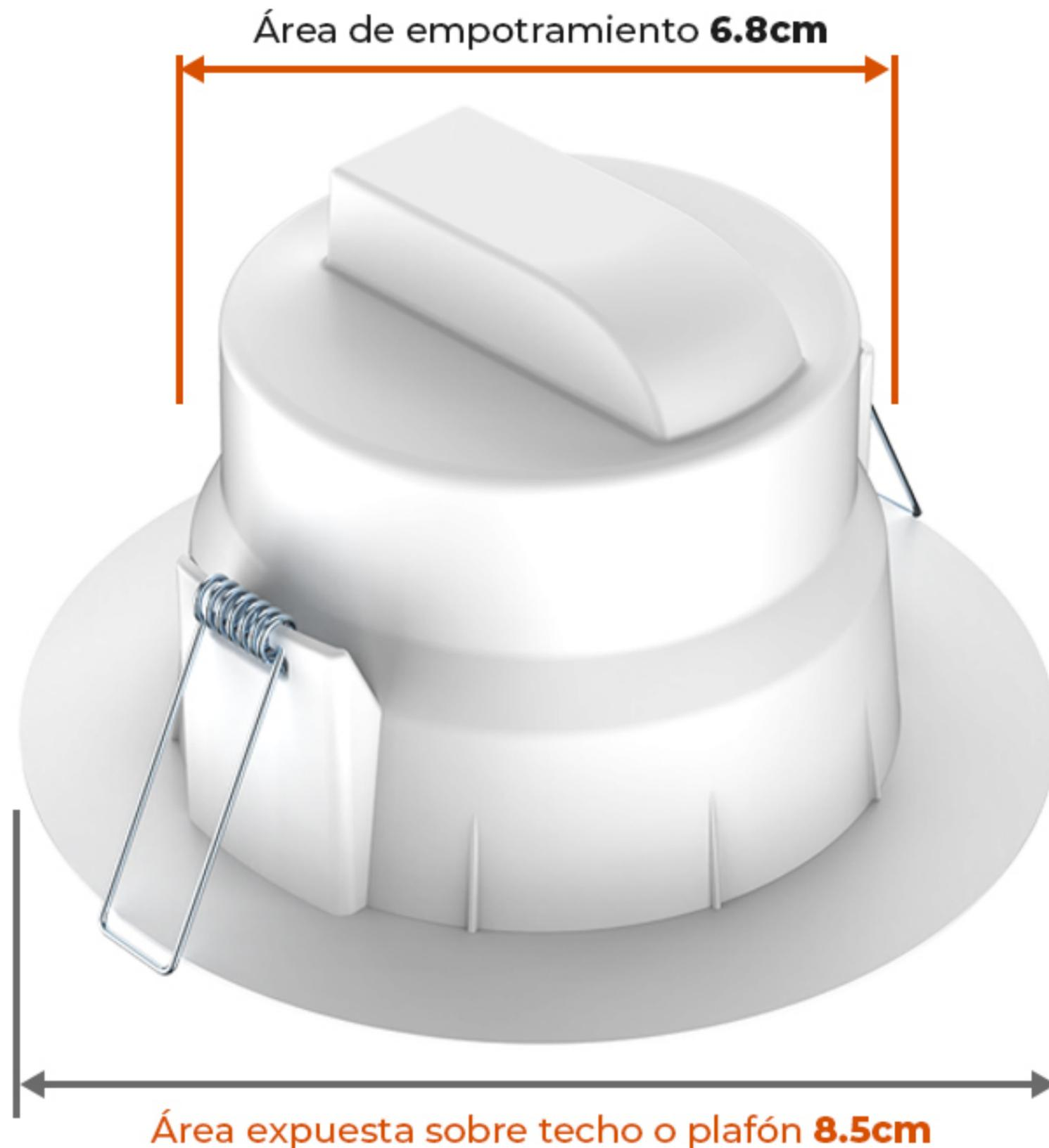
El **corte de empotramiento** en el techo siempre será con la medida interna de la lámpara.
