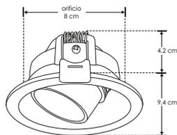
**NOTA:** Este producto es usado como difusor de lámparas tipo MR16, GU10 cuyo diámetro sea igual a 5 cm y con módulos de LED (ILUMOD). Incluye base GU10. Compatible con bote integral de 8.5cm. No incluye lámpara.
