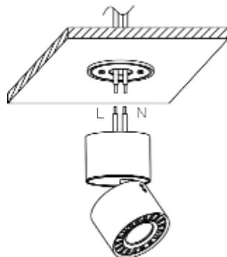
CONECTE LA LUZ A LA TERMINAL DE SALIDA DEL LUMINARIO
